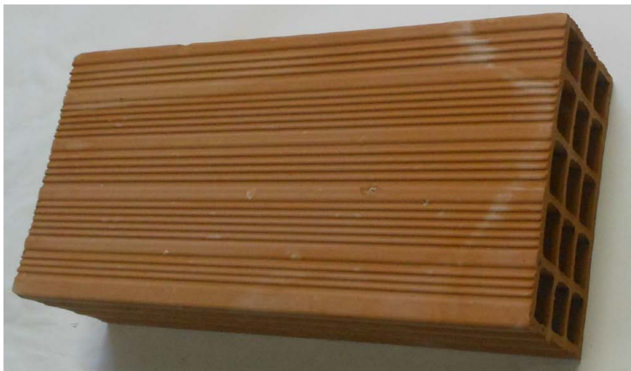
Figura 1. Riproduzione fotografica di un provino tal quale del prodotto “CF12005 – Forato 12x24x50”.
